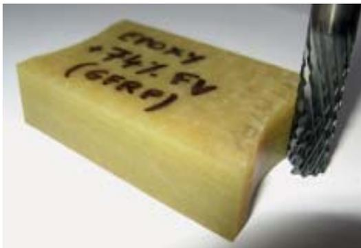
Kompressionsfräser sind insbesondere für die Bearbeitung von Kunststoffen auf Epoxidharz- oder Polyesterbasis mit Carbon- oder Glasfasern vorgesehen und machen es möglich Oberflächen in Schlichtqualität ( $ra < 2 \mu m$ ) zu fertigen.
